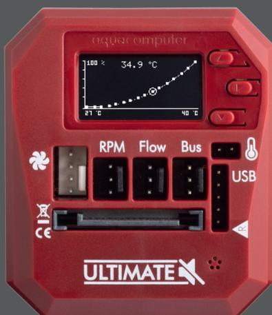
Eine weitere Option für die aquastream ULTIMATE ist das erweiterte Reglerpaket. Mit Hilfe dieses Paketes werden weitere Regler in der Pumpe freigeschaltet. Es können die Lüfter neben der Sollwertregelung durch einen Kurvenregler und einen Zweipunktregler gesteuert werden. Der Kurvenregler bietet die Möglichkeit, grafisch eine Kurve zwischen Temperatur und Lüfterleistung zu definieren. Der Zweipunktregler ermöglicht das Schalten des Lüfterausgangs bei einstellbaren Temperaturwerten.
