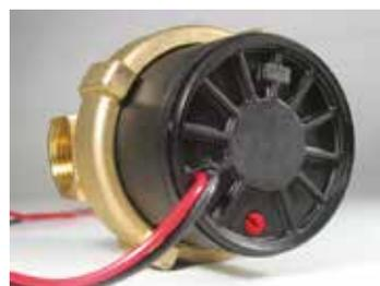
Variiert die Spannung während des Betriebs, zum Beispiel bei einem Solarpanel, behält die Pumpe trotzdem die eingestellte Drehzahl bei, solange die Spannung hierfür ausreicht. Dadurch ändert sich der aufgenommene Strom entsprechend. Dies ist überall dort von Vorteil, wo eine bestimmte Pumpleistung bei variabler Versorgungsspannung gewährleistet werden muss.
